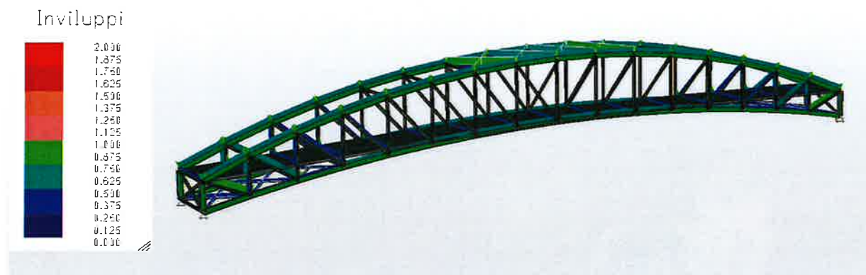
Soluzione proposta : Inviluppi verifiche elementi in acciaio ponte
