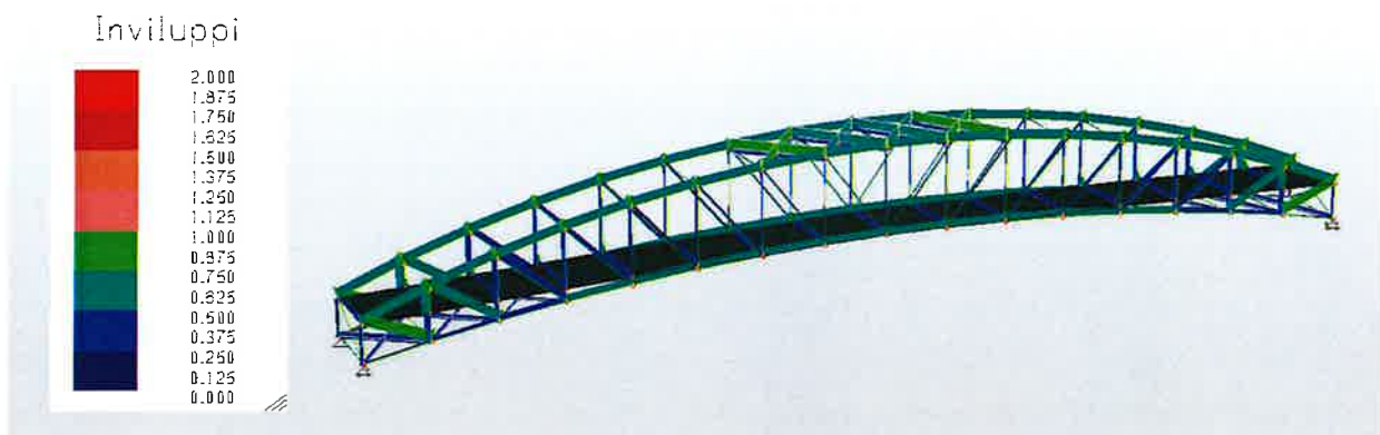
Progetto definitivo : Inviluppi verifiche elementi in acciaio ponte
